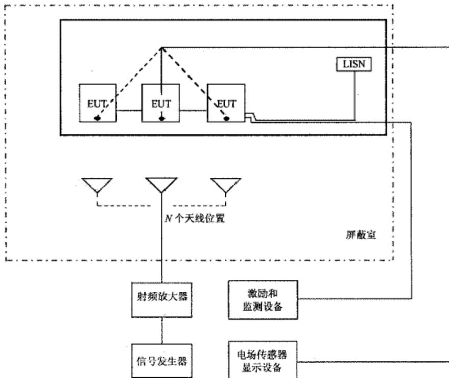
图 4-5 多天线测试配置 (频率  $> 200\text{ MHz}$ )
